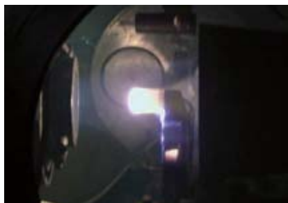
図2 UHTCコーティングC/C複合材のアーク加熱風洞試験の様子
