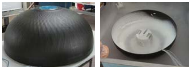
図4 極低温CFRPタンクモデル(左)と冷却試験の様子(右)
