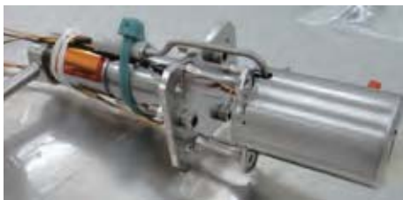
図1 新規に開発した1液式1Nスラスタ
