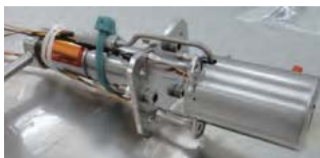
図1 新規に開発した1液式1Nスラスタ
